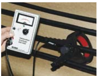
Anwendung des Ausleseempfängers mit Stromwandlerzange
