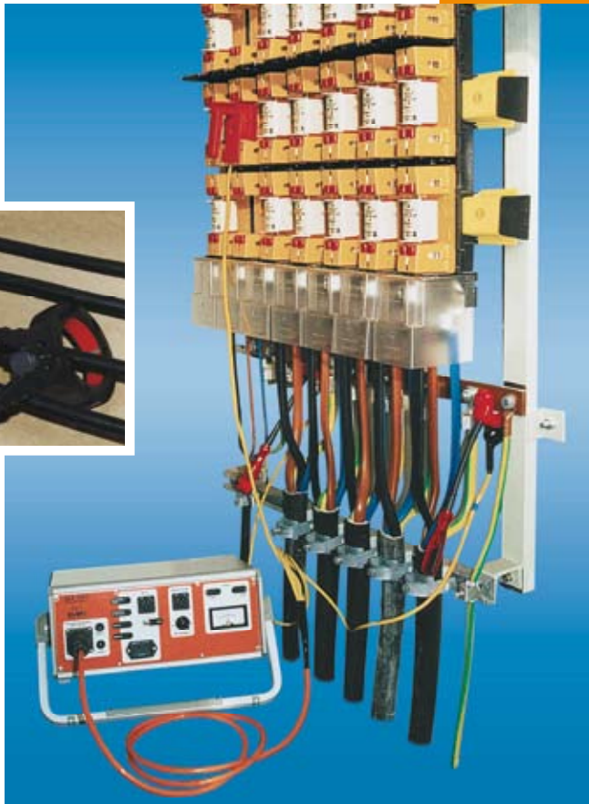
Anwendung des Ausleseempfängers mit Stromwandlerzange
